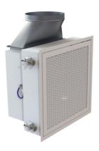
Ein hoher Luftdurchsatz bei begrenzter Einbautiefe kann mit einem rechteckigen Auslassflansch (nur 424 mm Tiefe bei der 6P6-Version) bewältigt werden. Der asymmetrische Luftkanaladapter ermöglicht den Anschluss einer runden Luftleitung, ohne die Einbautiefe zu vergrößern.
